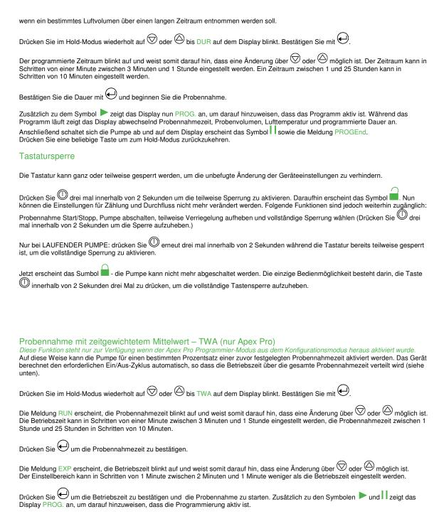
Die Einschaltzeiten der Pumpe sind auf 1 Minute festgelegt. Das Gerät berechnet die erforderlichen Aus-Zeiten, um diese einminütigen Intervalle auf die Probennahmezeit zu verteilen. Während das Programm läuft zeigt das Display abwechselnd die Gesamtprobenzeit, das Probenvolumen, die Lufttemperatur und den berechneten TWA (als Prozentsatz der Betriebszeit).
