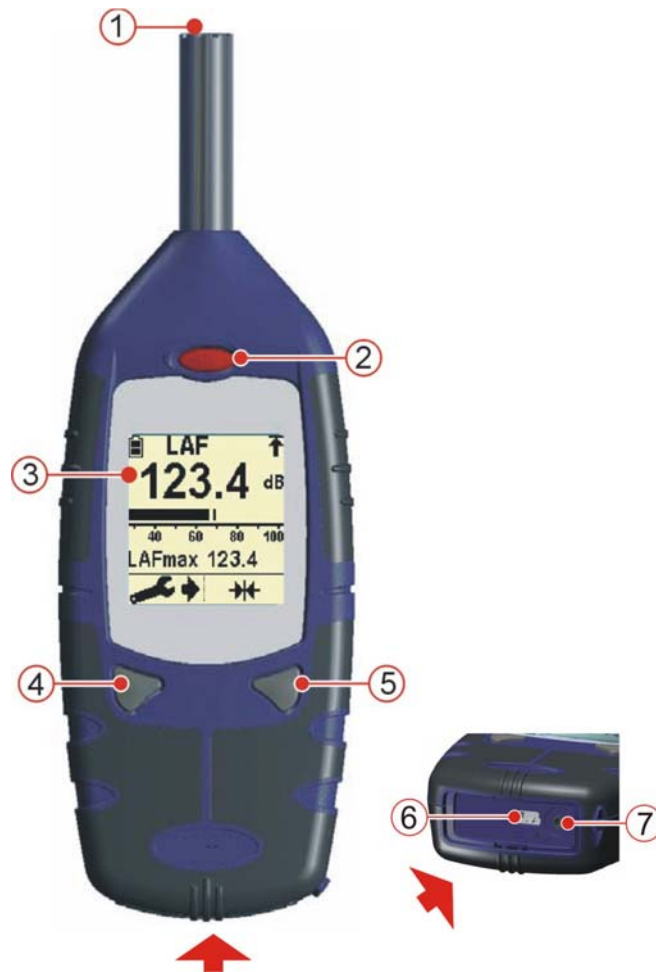
Abbildung 1 digitaler Lärmpegelmesser der CEL-200 Serie
