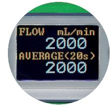
Aktuelle und durchschnittliche Durchflussrate wird angezeigt, und die Mittelungszeit kann nach Bedarf eingestellt werden.
